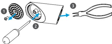
1. Sprayeinsatz mit Kreuzschraubendreher entfernen.
