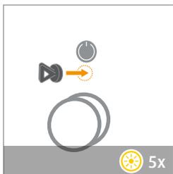
1. Heranführen des Magnetstiftes unterhalb des Infrarot-Sensors.
